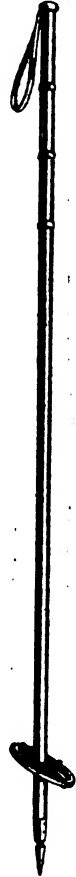
FIG. 19. — Ferrure à pi- que dange- reuse : bâton sur lequel un skieur s'est percé la gor- ge.
